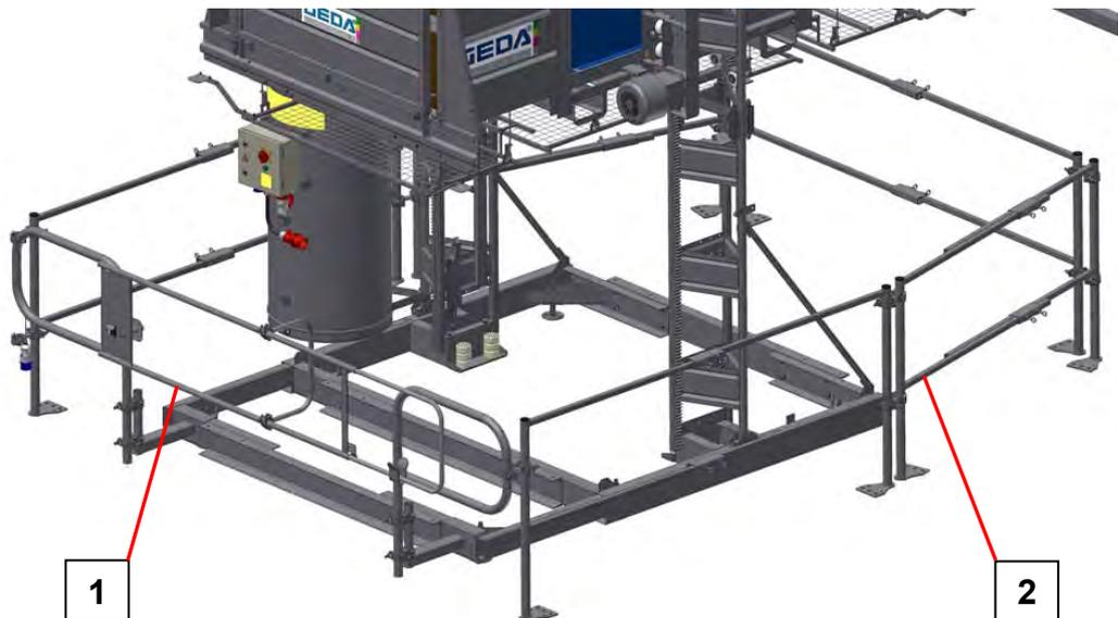
Die Länge der Umweh rungselemente kann der Bühnenform angepasst werden.
